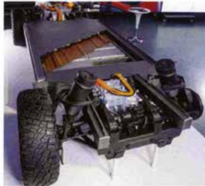
Le batterie Ultium di GM saranno più sottili, racchiuse in un sacco (pouch) e potranno impilare celle in orizzontale e in verticale.
